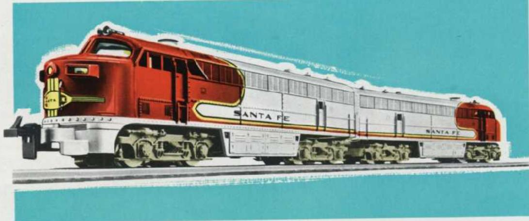
**2264 • Modell-Diesellok** für Gleichstromfahrbetrieb • Amerikanische Bauart der Fairbanks Morse für die Bahngesellschaft „Santa Fe“ • zweiteilig • das hintere Drehgestell des Motorwagens angetrieben • Plastikreifen • ferngesteuert vor- und rückwärtsfahrend • am Motorwagen leuchtende Stirnlampen • Plastikausführung • sehr ansprechende Farbgebung • attraktives Modell • Länge ca. 41 cm DM 65,—
