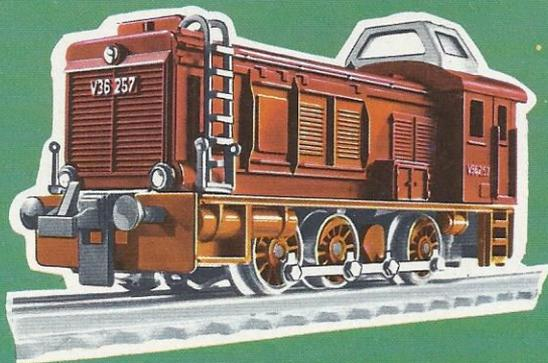
Diese noch heute in großer Stückzahl bei der DB in Betrieb befindliche V 36 wird vornehmlich im Rangierbetrieb sowie Nahverkehr und Nebenbahnen eingesetzt.
