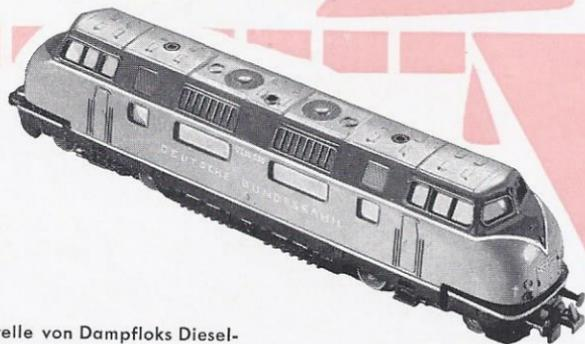
Die Deutsche Bundesbahn ist in den letzten Jahren dazu übergegangen, an Stelle von Dampfloks Dieselloks einzusetzen. Die Diesellok V 200 hat 2 Motore mit je 1000 PS und hydraulischen Antrieb. Die Höchstgeschwindigkeit der Maschine beträgt ca. 140 km/h.
