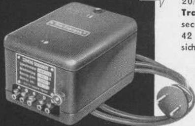
20/147/220 oder /110 • **Trafo** für 220 oder 110 Volt • sekundär 2, 4, 10, 14 V, 42 VA • mit Kurzschlußsicherung (VDE) • DM 37.50
