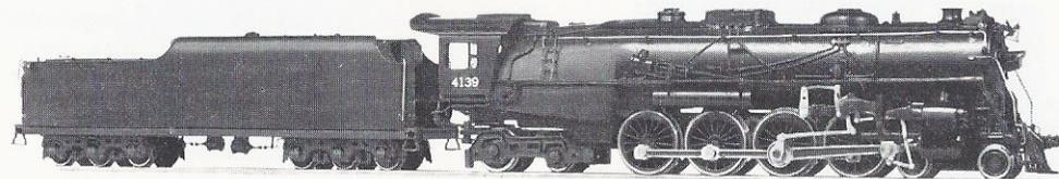
Bild 47 H0-Modell einer 4-8-4 Lok in Ganzmessingbauweise.
