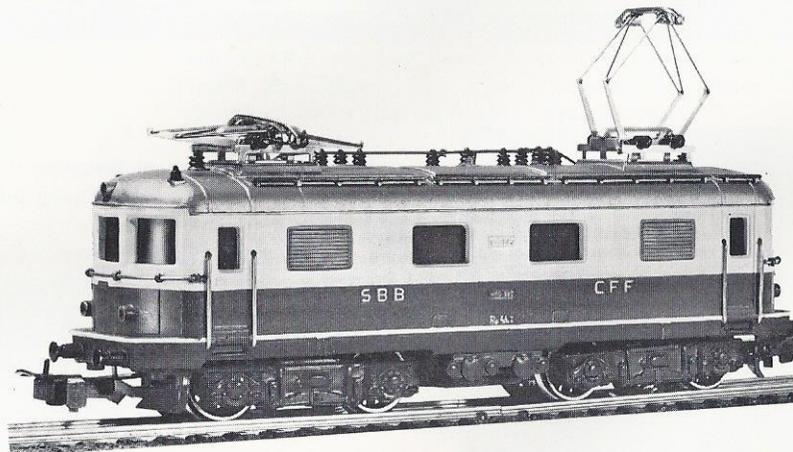
Bild 118 Was man aus einer Märklinlok 3014 der schweizer Re 4/4 machen kann: mit TEE-Lackierung, erweiterter und geänderter Beschilderung und mit Verschluß der alten großen Lampenlöcher und Einbau neuer A-Beleuchtung und Griffstangen entstand eine ganz neue Maschine.
