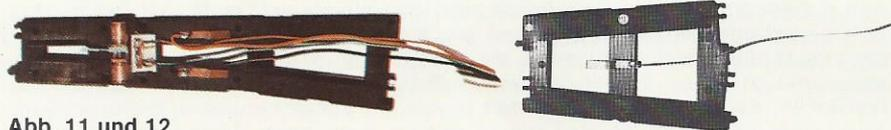
Abb. 11 und 12 Weichenhalteplatte mit Antrieb und Kontakten sowie Herzstückhalteplatte mit Kontakt.
