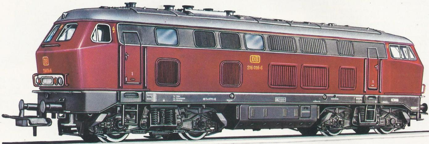
Absolut maßstäbliches HO-Modell der Diesellokomotive Reihe 216 (V 160) der DB mit Federpuffer.
