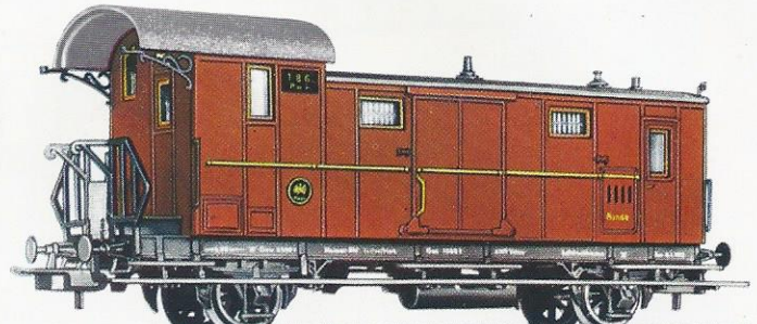
Gepäckwagen PwiPr99 , Wagenkasten rot, Chassis graphitgrau, mit Korbpuffern, Holztreppen, Dächer mit Dachpappenimitation, Speichenräder, 2achs.
