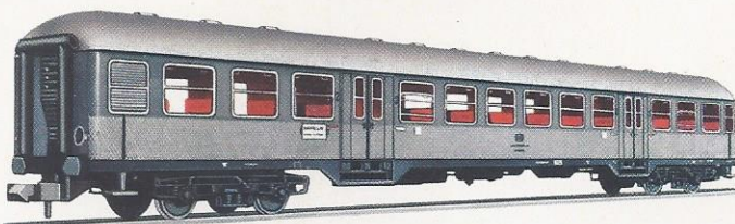
DB-Nahverkehrswagen mit Steuerabteil BD4nf Ausführung wie 8201 mit Steuer-Gepäck- und 2.-Klasse-Abteil, funktionsfähiges A-Spitzensignal und Schlußlicht mit Fahrtrichtung wechselnd, Wagenbeleuchtung. Länge über Puffer 16,5 cm. 8203
