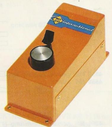
**0902 ELEKTRONISCHER REGELTEIL** zum Universaltrafo 0903, an diesen seitlich ansteckbar, mit stufenloser Spannungsregelung und Polumschalter mit „0“-Stellung. **Stromkreisgänge:** Anschlußklemmen stirnseitig = 0–14 V eff., stufenlos regelbar (Restspannung in der Minimumstellung ca. 1 V), Anschlußbuchsen seitlich ~ 15 V eff. Die Regelteile sind baukastenmäßig aneinander ansteckbar, somit können mehrere getrennte Stromkreise völlig unabhängig voneinander geregelt werden.
