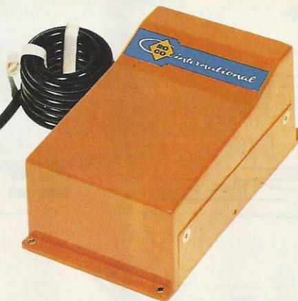
**0903 UNIVERSAL-TRANSFORMATOR**, dient als Grundgerät bei einer Modellbahnanlage zur Stromspeisung der elektronischen Regelteile 0902, der Beleuchtung sowie der Steuer- und Antriebselemente (Weichenantriebe, Signale etc.). **Netzanschluß:** 220 V Wechselstrom **Leistung:** 35 VA eff. **Stromkreisgänge:** Anschlußklemmen stirnseitig ~ 15 V eff., Anschlußbuchsen seitlich ~ 15 V eff., gesamtzulässige Belastung 2,5 A.
