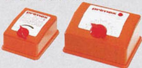
Wenn Sie die beiden Gleisovals durch Mittelleiterisierungen trennen, können Sie sowohl den inneren, wie auch den äußeren Stromkreis jeweils an einen anderen Transformator anschließen. Die Züge können dann unabhängig voneinander betrieben werden.
