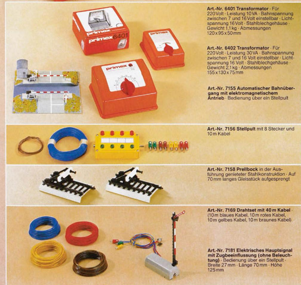
Art.-Nr. 6401 Transformator · Für 220 Volt · Leistung 10 VA · Bahnspannung zwischen 7 und 16 Volt einstellbar · Lichtspannung 16 Volt · Stahlblechgehäuse · Gewicht 1,1 kg · Abmessungen 120 x 95 x 50 mm
