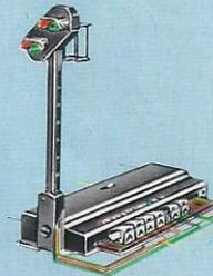
auf Grün/Grün (Vr1) oder Gelb/Grün (Vr2) durch 4 Glühlampen · Elektromagnetischer Doppelspulenantrieb für die Stellung Gelb/Grün · Zur Verwendung mit Lichthauptsignal 7241 · Mit Bodenplatte · Breite 30 mm · Länge 70 mm · Höhe 67 mm
