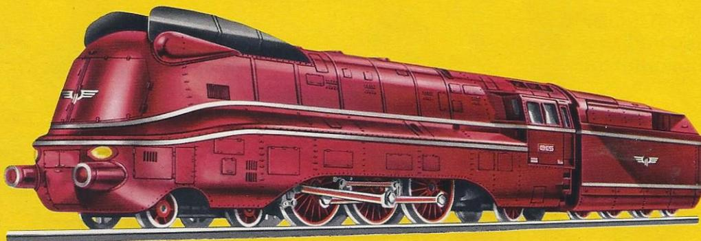
*Nachdem sich bei anderen Lokomotiven die Stromlinienverkleidung zur Verringerung des bei Schnellfahrten hohen Luftwiderstandes bereits bewährt hatte, wurde ab 1937 die mit Drillingstriebwerk ausgerüstete Baureihe 03<sup>10</sup> ebenfalls mit einer Verkleidung in Dienst gestellt,*
