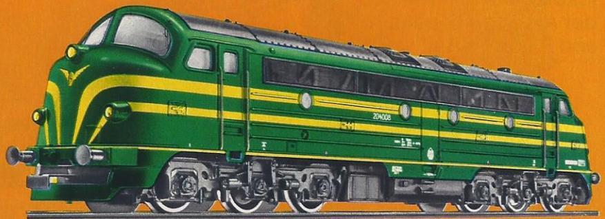
*Die belgische Mehrzweck-Diesellokomotive Typ 204 wird diesel-elektrisch angetrieben. Mit ihrer rund 1300-kW-Antriebsleistung wird sie vor leichten Güterzügen, aber auch vor Personen- und Schnellzügen eingesetzt und erreicht 140 km/h Höchstgeschwindigkeit.*
