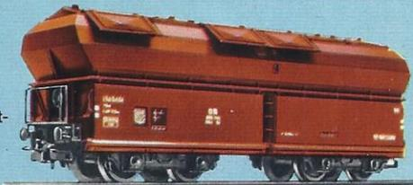
*Diese Wagenart wird im internationalen Verkehr zur Beförderung von Kohle, Koks, Erz usw. verwendet. Der Einsatz erfolgt in der Regel in geschlossenen Großraumzügen.*
