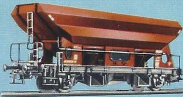
Entladeklappen durch Handhebel und auch ferngesteuert unter Verwendung des Entkupplungsgleisstückes 5112 (Seite 58) und 2197 (Seite 60) zu öffnen.
