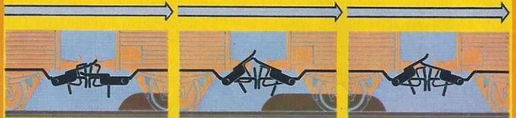
Durch Heben der Kuppelbrücke wird die Kupplung geöffnet.
