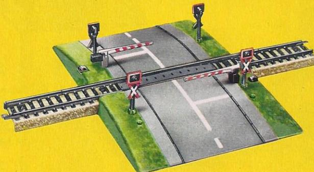
*Gesicherte Bahnübergänge mit selbsttätigen Schranken. Schon wenn sich ein Zug dem Bahnübergang nähert und dabei auf die Kontaktgleisstücke fährt, schließen sich die Schranken. Sie öffnen sich erst wieder, nachdem der letzte Wagen die nach der Schranke befahrenen Kontaktgleise verläßt.*
