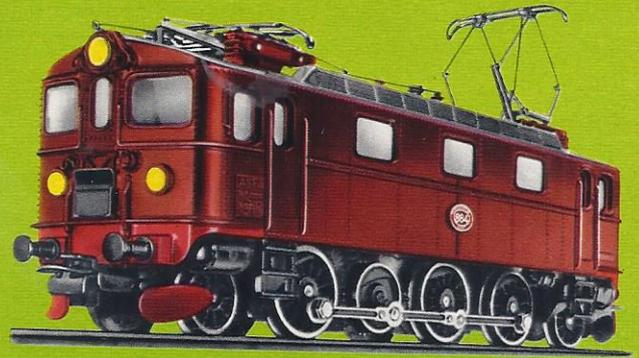
*Der Typ Da wird von den Schwedischen Staatsbahnen (Statens Järnvägar) als Standard-Elektrolok vor Personen- und Güterzügen gefahren. Weil diese Maschinen nur einen Motor haben und der*
