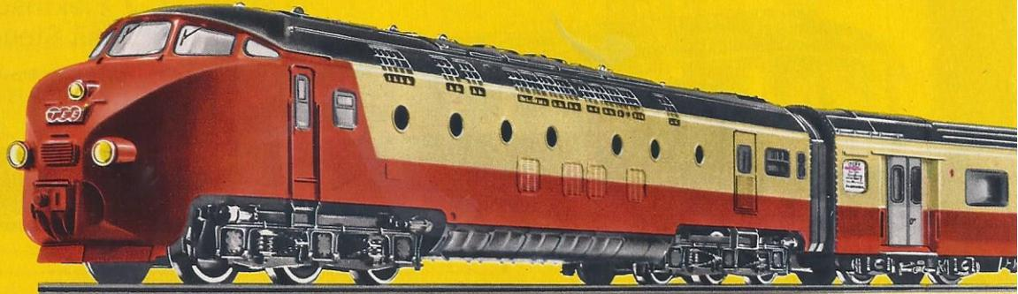
Sonderkupplungen verbinden die 3 Einheiten sehr kurz miteinander · Besonders eng schließende Abdeckungen der Wagenübergänge · Dreilicht-Spitzen-signal und 2 rote Schlußleuchten im Motor- und Steuerwagen werden entsprechend der Fahrtrichtung beleuchtet
