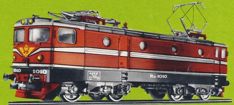
*Bei dieser sehr modern konstruierten Maschine wird der aus der Fahrleitung entnommene 16 $\frac{2}{3}$ -Hz-Wechselstrom durch Thyristoren in Gleichstrom ver-*
