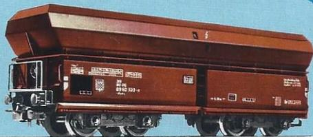
*Diese Wagenart wird im internationalen Verkehr zur Beförderung von Kohle, Koks, Erz usw. verwendet. Der Einsatz erfolgt in der Regel in geschlossenen Großraumzügen.*
