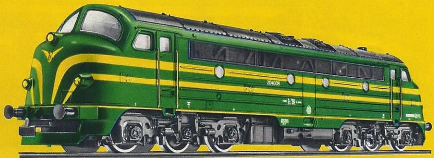
*Die belgische Mehrzweck-Diesellokomotive Typ 204 wird diesel-elektrisch angetrieben. Mit ihrer rund 1300 kW (1750 PS) Antriebsleistung wird sie vor leichten Güterzügen, aber auch vor Personen- und Schnellzügen eingesetzt und erreicht 140 km/h Höchstgeschwindigkeit.*
