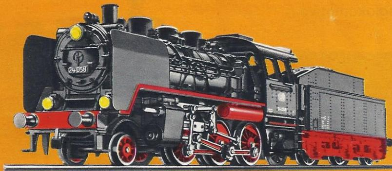
Die Einheitslokomotive der Baureihe 24 wurde bei der Deutschen Bundesbahn zur Beförderung von Personen- und Güterzügen eingesetzt. Ihre Höchstgeschwindigkeit betrug 90 km/h.
