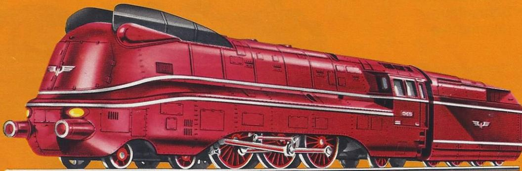
*Nachdem sich bei anderen Lokomotiven die Stromlinienverkleidung zur Verringerung des bei Schnellfahrten hohen Luftwiderstandes bereits bewährt hatte, wurde ab 1937 die mit Drillingstriebwerk ausgerüstete Baureihe 03<sup>10</sup> ebenfalls mit einer Verkleidung in Dienst gestellt,*
