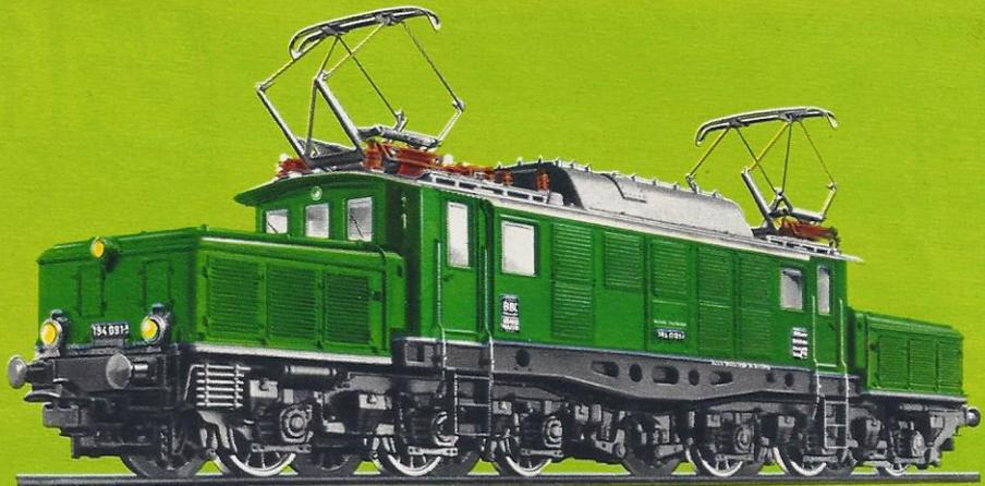
Diese Lokomotive der Baureihe 194 ist ein Schwerathlet. Mit ihrer Anfahrleistung bringen die 6 Motoren etwa 4670 kW (6350 PS) an die Räder. Bei dem Gesamtgewicht der Maschine von 120 t hat sie eine maximale Anfahrzugkraft von 40 t.
