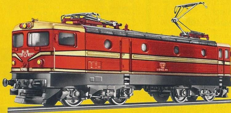
*Nach ausgedehnten Probefahrten mit der von der schwedischen Firma ASEA erbauten Lokomotive erwarben die Österreichischen Bundesbahnen zunächst 4 dieser Maschinen, die unter der Baureihenbezeichnung 1043 in Dienst gestellt wurden. Durch Thyristoren wird der der*
