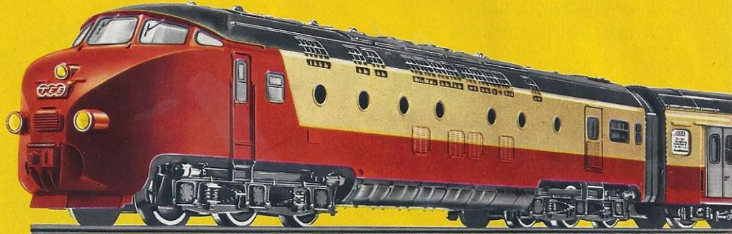
Sonderkupplungen verbinden die 3 Einheiten sehr kurz miteinander · Besonders eng schließende Abdeckungen der Wagenübergänge · Dreilicht-Spitzen-signal und 2 rote Schlußleuchten im Motor- und Steuerwagen werden entsprechend der Fahrtrichtung beleuchtet ·
