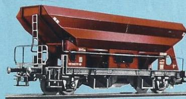
*Entladeklappen durch Handhebel und auch ferngesteuert unter Verwendung des Entkopplungsgleisstückes 5112 (Seite 54) und 2197 (Seite 56) zu öffnen.*
