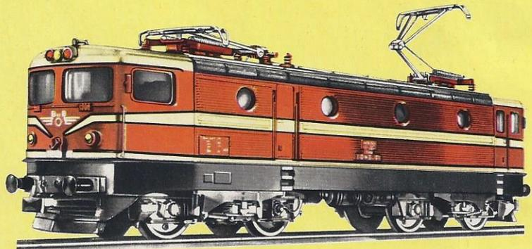
*Nach ausgedehnten Probefahrten mit der von der schwedischen Firma ASEA erbauten Lokomotive erwarben die Österreichischen Bundesbahnen zunächst 4 dieser Maschinen, die unter der Baureihenbezeichnung 1043 in Dienst gestellt wurden. Durch Thyristoren*
