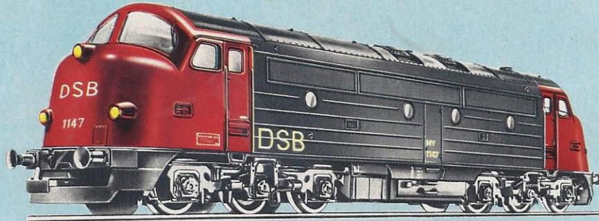
*Diese Mehrzwecklokomotiven, Serie My 1100 der Dänischen Staatsbahnen (DSB), werden diesel-elektrisch angetrieben. Das heißt, der Strom für die an den Achsen liegenden Antriebsmotoren wird in der Lokomotive von Generatoren erzeugt, die ihrerseits von Diesel-*
