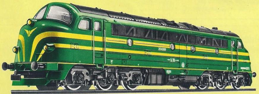
*Die belgische Mehrzweck-Diesellokomotive Typ 204 wird diesel-elektrisch angetrieben. Mit ihrer 1750-PS-Antriebsleistung wird sie vor leichten Güterzügen, aber auch vor Personen- und Schnellzügen eingesetzt und erreicht 140 km/h Höchstgeschwindigkeit.*
