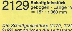
Die Schaltgleisstücke (2129, 2139, 2199) ermöglichen die selbsttätige Steuerung von Magnetartikeln durch den fahrenden Zug. Vom Schleifer der Fahrzeuge betätigt, können sie in jeder Richtung, unabhängig von der anderen, verschiedene Schaltfunktionen auslösen. Abnahme der
