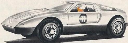
**Sportwagen** · Modell des Mercedes C 111 · Vorderachse pendelnd gelagert · Antrieb über Stirnräder · Karosserie weiß · Untergestell schwarz · Eingesetzte Fenster · Länge 12 cm · Hierzu passende Ersatzreifen: vorn 1500, hinten 1503
