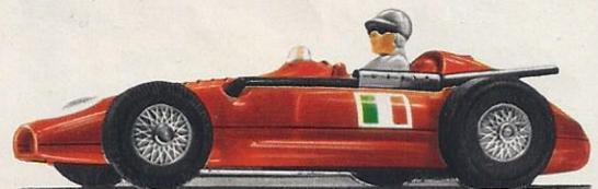
Vorderräder durch die Spurrille der Fahrbahnstücke gelenkt. Vorbildgetreue Achsschenkelagerung. Stromabnahme durch 2 gefederte Ski-schleifer.
