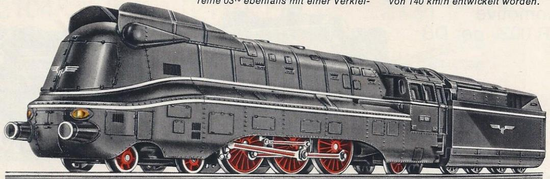
Nachdem sich bei anderen Lokomotiven die Stromlinienverkleidung zur Verringerung des bei Schnellfahrten hohen Luftwiderstandes bereits bewährt hatte, wurde ab 1937 die mit Drillingstriebwerk ausgerüstete Baureihe 03<sup>10</sup> ebenfalls mit einer Verklei-
