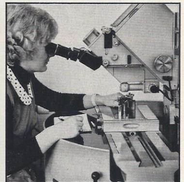
Formen und Werkzeuge werden für eine Fertigung erst nach eingehenden Mikroskopmessungen freigegeben.
