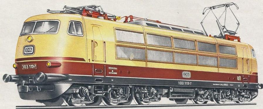
*Das ist zur Zeit die eleganteste, stärkste und schnellste elektrische Schnellfahrlokomotive der Deutschen Bundesbahn. Sie ist 19,50 m lang, die 6 Achsen werden von 6 Motoren angetrieben. Ihre Stundenleistung von*
