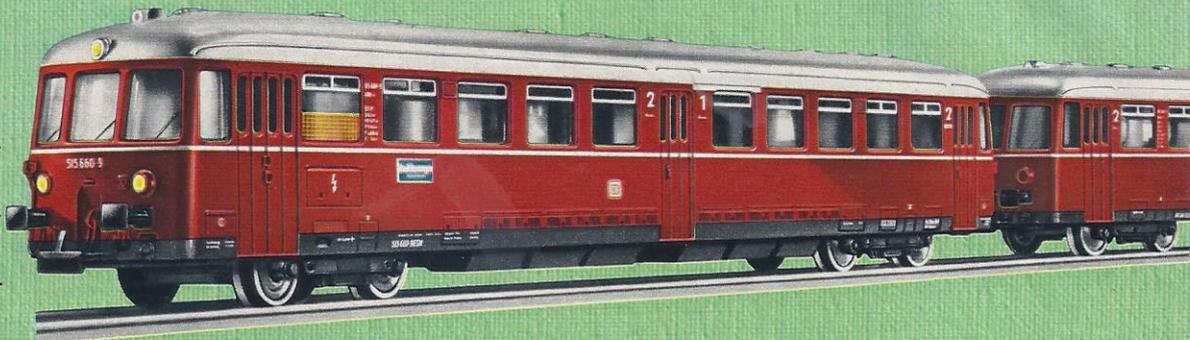
Akkumulatorentriebwagen der Baureihe 515 – meist mit dem Steuerwagen 815 gekoppelt – werden auf Haupt- und Nebenstrecken im Eil- und Personenzugdienst verwendet. Ihr Fahrbereich ist, bedingt durch die Leistungsfähigkeit der als Energiequelle mitgeführten Batterie, auf
