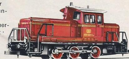
beiden Enden automatische Kupplung · Länge über Puffer 49 mm
