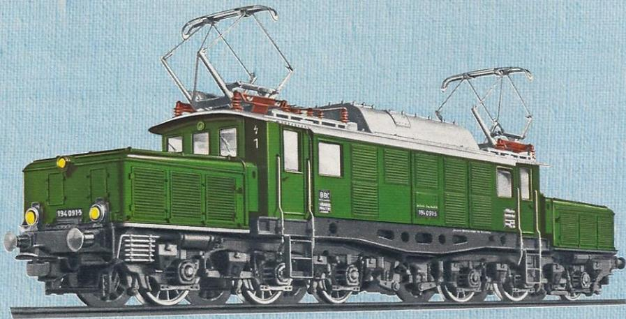
*Diese Lokomotive der Baureihe 194 ist ein Schwerathlet. Mit ihrer Anfahrleistung bringen die 6 Motoren etwa 6350 PS an die Räder. Bei dem Gesamtgewicht der Maschine von 120 t hat sie eine maximale Anfahrzugkraft von 40 t. Sie kommt zwar nur auf*
