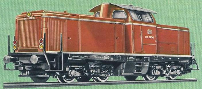
**Diesel-hydraulische Lokomotive »212« 3072**
