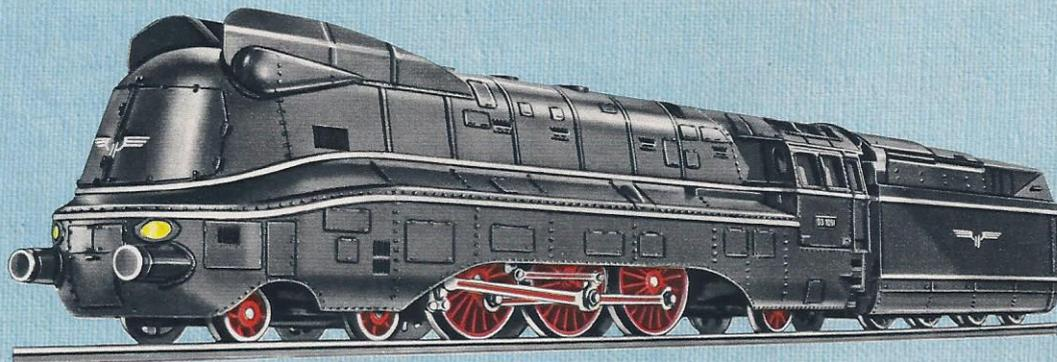
*Nachdem sich bei anderen Lokomotiven die Stromlinienverkleidung zur Verringerung des bei Schnellfahrten hohen Luftwiderstandes bereits bewährt hatte, wurde ab 1937 die mit Drillingstriebwerk ausgerüstete Baureihe 03<sup>10</sup> ebenfalls mit einer Verkleidung in Dienst gestellt, bei der*
