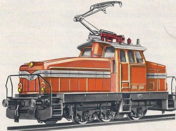
*Die Lokomotiven dieser Art wurden für den schweren Strecken- und Rangierdienst auf Industriebahnen sowie für den Übergabeverkehr zur DB gebaut. Sie können ihre Antriebsenergie sowohl aus der Fahrleitung als auch aus der mitgeführten Batterie entnehmen. Ihre Höchstgeschwindigkeit beträgt 50 km/h. Die mit Einzelachsantrieb ausgestattete Lok vermag eine Anfahrzugkraft von maximal 19500 kg zu entwickeln. Sie wiegt 60 t und hat eine Länge von 10,20 m.*
