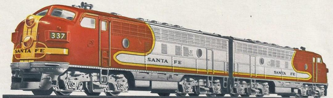
Am Fahrzeugende automatische Kupplung mit Vorentkupplung (RELEX) · Länge 17,5 cm
