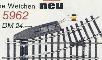
**5962 ELEKTROMAGNETISCHE WEICHE LINKS** · Mit Doppelspulen-antrieb · Federnd anliegende Zungen · Weichenwinkel 30° · Radius des Zweiggleises 600 mm · Länge des geraden Gleisstranges 300 mm
