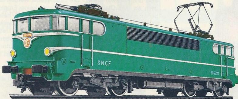
Das französische Vorbild unseres Modells 3038 fährt auf einigen Strecken der SNCF mit 160 km/h Höchstgeschwindigkeit. Die Lokomotiven der Baureihe BB 9200 haben 4 Fahrmotoren mit zusammen 5 500 PS Stundenleistung; sie wiegen 80 t.
