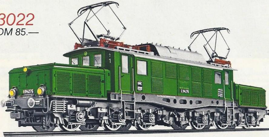
Diese Lokomotive der Baureihe 194 (E 94) ist ein Schwerathlet. Mit ihrer Anfahrleistung bringen die 6 Motoren etwa gute 6350 PS an die Räder. Bei dem Gesamtgewicht der Maschine von 120 t hat sie eine maximale Anfahrzugkraft von 40 t. Sie kommt zwar nur auf etwa 90 km/h als Höchstgeschwindigkeit, ist andererseits aber auch mit dem schwersten Güterzug vor keiner Steigung bange. 124 Stück dieser 18,60 m langen Riesen fahren bei der Bundesbahn.
