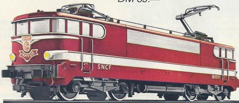
Für den französischen Fernschnellzug »Le Capitole« war die Normalausführung dieser Lokomotive der Baureihe 9200 nicht schnell genug. Deshalb wurde das Getriebe geändert. Mit der geänderten Übersetzung fährt dieses »Paradepferd« mit einer Zuglast von 400 t die respektable Höchstgeschwindigkeit von 200 Stundenkilometer.
