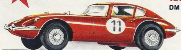
**1308 SPORTWAGEN** · Modell des Jaguar Type E · Vorderachse pendelnd gelagert · Vorderräder durch Spurrille der Fahrbahn gelenkt · Vorbildgetreue Achsschenkellagerung · Antrieb über Stirnräder auf die Hinterachse · Stromabnahme durch 2 gefederte Skischleifer · Rotes Kunststoffgehäuse · Eingesetzte Fenster · Fahrerfigur · Länge 13,4 cm · Hierzu passende Ersatzreifen: vorn und hinten 1500
