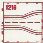
**ENGSTELLE GERADE** · Doppelspurig · Verminderung des Spurbstandes von 75 auf 38 mm · Länge 150 mm
