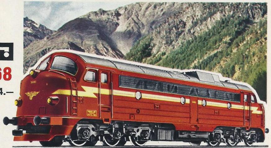
*Soweit die Strecken der Norwegischen Staatsbahnen noch nicht elektrifiziert sind, geht man dort mehr und mehr zum Dieselmotor über. Das Original unserer Modell-Lok hat die Typenbezeichnung Di 3. Mit ihrem 1900-PS-Motor erreicht die Maschine 100 km/h Höchstgeschwindigkeit. Bis auf die Dachausrüstung ist die Verwandtschaft mit der belgischen Type 204 und der dänischen My 1100 unverkennbar.*
