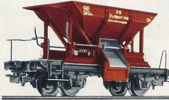
4610 SCHOTTERWAGEN mit durch Handhebel zu betätigenden Entladeklappen · Braun · Länge 9,5 cm
