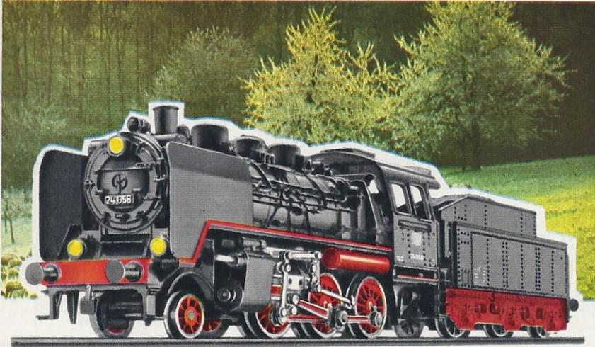
Die Einheitslokomotive der Baureihe 24 wurde bei der Deutschen Bundesbahn zur Beförderung von Personen- und Güterzügen eingesetzt. Ihre Höchstgeschwindigkeit betrug 90 km/h.
