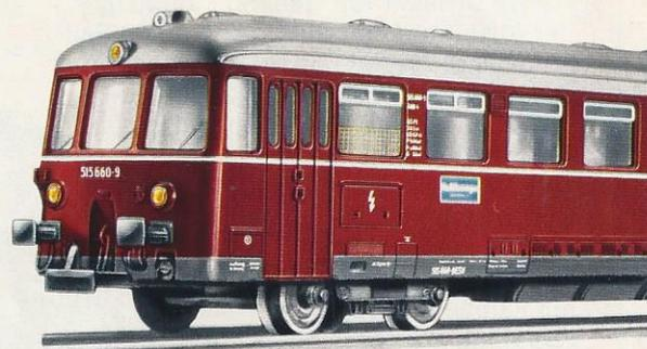
Akkumulatorentriebwagen der Baureihe 515 (ETA 150) – meist mit dem Steuerwagen 815 (ESA 150) gekoppelt – werden auf Haupt- und Nebenstrecken im Eil- und Per-
