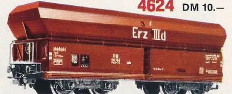
Diese Wagenart wird im internationalen Verkehr zur Beförderung von Kohle, Koks, Erz usw. verwendet. Der Einsatz erfolgt in der Regel in geschlossenen Großraumzügen.
