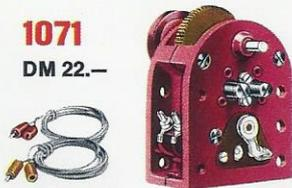
1071 ELEKTROMOTOR · Umschaltbar für Rechts- bzw. Linkslauf · Leerlaufdrehzahl etwa 1500 U/min · Für 16-Volt-Betrieb, daher an jeden MÄRKLIN-Eisenbahn-Transformator anzuschließen · Zubehör: 2 Kabel · Höhe 6,5 cm · Breite 5 cm · Tiefe 5 cm · Gewicht 200 g
