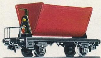
**Kippwagen** · Rot · Nach zwei Seiten entleerbar · Mit Sperrvorrichtung · Länge 8,5 cm
