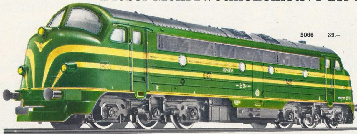
Die Lokomotiven der belgischen Type 204 werden auch im grenzüberschreitenden Verkehr nach Deutschland vor leichten Güter- sowie vor Personen- und Schnellzügen eingesetzt. Sie besitzt diesel-elektrischen Antrieb mit einer Gesamtleistung von 1750 PS und erreicht damit eine Höchstgeschwindigkeit von 140 km/h.
