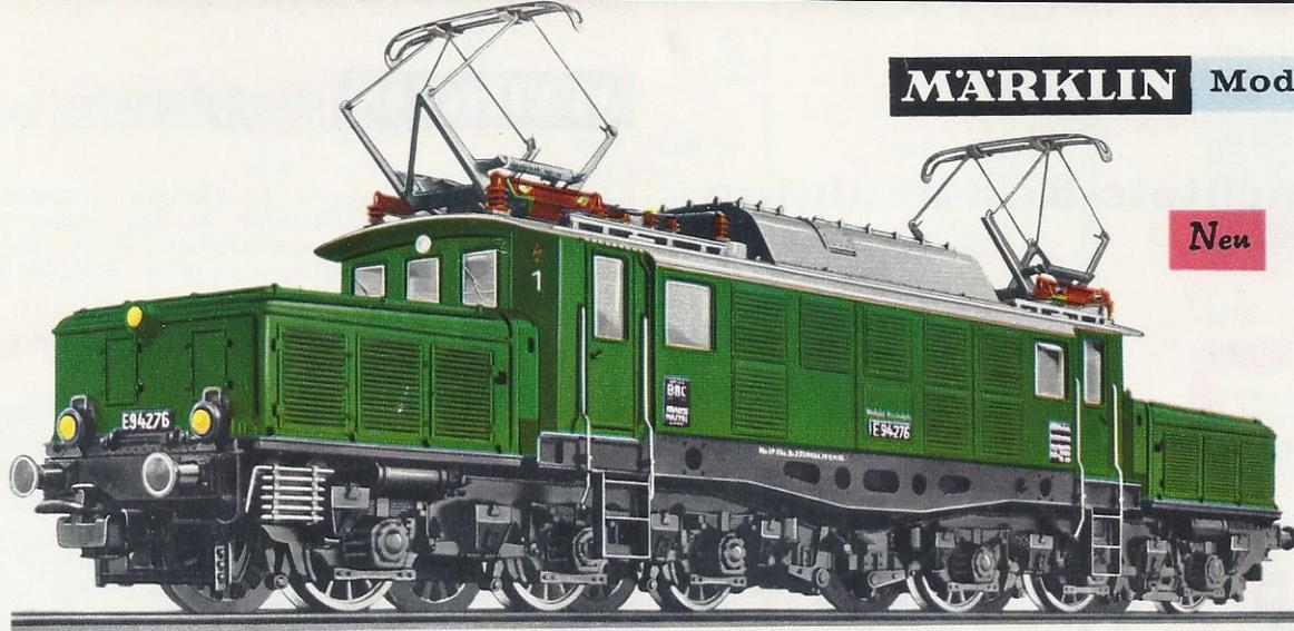
Von der schweren Güterzuglokomotive E 94 befinden sich 124 Exemplare im Bestand der DB. Mit ihren 6 Fahrmotoren, deren Stundenleistung 3240 kW, etwa 4400 PS, beträgt, erreicht sie eine Höchstgeschwindigkeit von 90 km/h und eine maximale Anfahrzugkraft von 37 t. Ihr Gesamtgewicht beträgt 120 t.
