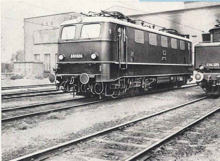
◀ Elektrische Lokomotive, Bauartreihe E 41 der Deutschen Bundesbahn; Vorbild der MÄRKLIN-Modelle 3034 und 3037.
