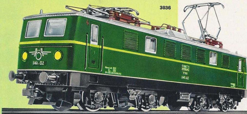
Das Vorbild dieses MÄRKLIN-Modelles ist bei den Österreichischen Bundesbahnen hauptsächlich auf Strecken mit günstigen Neigungs- und Richtungsverhältnissen eingesetzt. Diese Lokomotive besitzt ein Gewicht von 80 t und eine Stundenleistung von 3400 PS. Die Höchstgeschwindigkeit beträgt 110 km/h.
