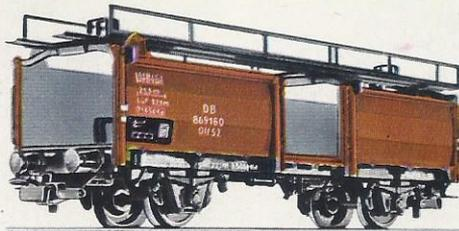
**4612 6.25 ▲ Autotransportwagen** mit Ladebrücke · Unbeladen · Braun, Brücke schwarz · Länge 11,5 cm · (Bei der Deutschen Bundesbahn werden immer 2 Transportwagen zu einer Einheit zusammengestellt unter der Bezeichnung Off 52)
