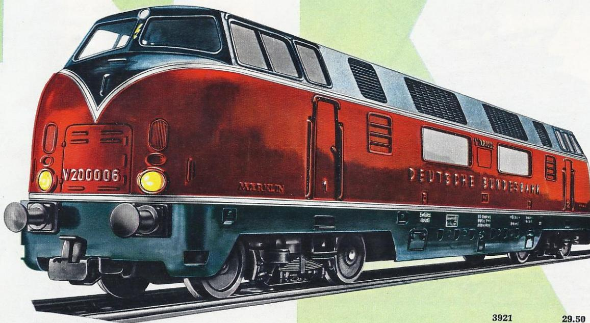
Die Diesellokomotive V 200 wird bei der Deutschen Bundesbahn an Stelle von Dampflokomotiven eingesetzt. Die V 200 ist eine dieseldieselmotivische Lokomotive mit zwei Motoren und 2 x 1000 PS Motorleistung. Sie wurde für eine Höchstgeschwindigkeit von 140 km/h gebaut und wird hauptsächlich im Schnellzugverkehr verwendet.
