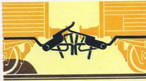
Durch Heben der Schaltbrücke wird die Kupplung geöffnet.
