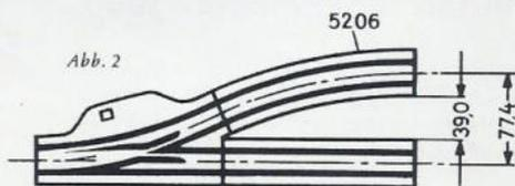
Bei einer Abzweigung wird der Gegenbogen bei den Weichen 5117 und 5121 (Abb. 1) von dem Gleisstück 5100 gebildet (Gleisabstand von Gleismitte zu Gleismitte 9,6 cm). Der Gegenbogen bei den Weichen 5202 (Abb. 2) dagegen wird von dem Gleisstück 5206 gebildet. Die um  $\frac{1}{6}$  im Bogen verkürzte Weiche ermöglicht den geringen Gleisabstand von 7,74 cm, gerechnet von Gleismitte zu Gleismitte.
