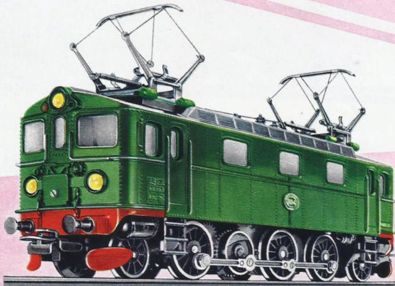
Auf den Strecken der Schwedischen Staatsbahnen (Statens Järnvägar) sind die Lokomotiven der Bauartreihe Da als Standardlokomotiven häufig zu sehen. Der Typ Da ist die neueste Lokomotive in dieser Reihe und wird sowohl für Personen- als auch für Güterzüge verwendet. Des geringen Achsdruckes wegen von nur 15 bzw. 17 Tonnen besteht die Möglichkeit, daß bei schweren Anfahrten einzelne Achsen durchgehen würden. Die Lokomotive ist deshalb mit Treibstangenantrieb ausgestattet.
