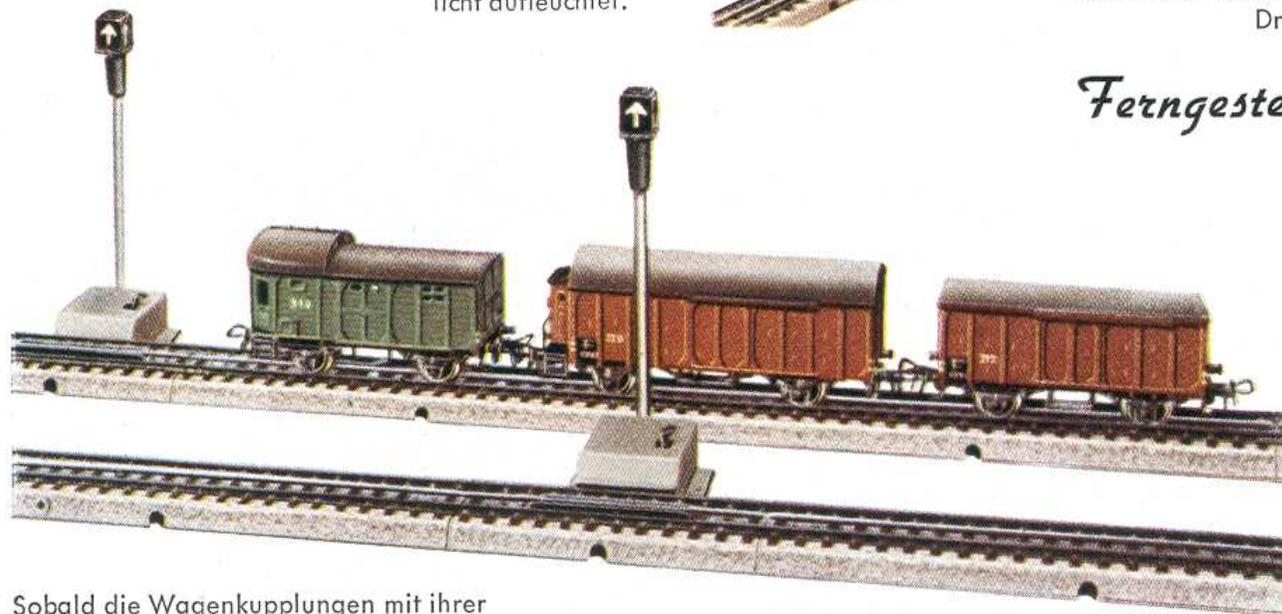
Sobald die Wagenkupplungen mit ihrer Winkellasse über den Entkupplungsbügel gleiten, werden sie ausgeklinkt.
