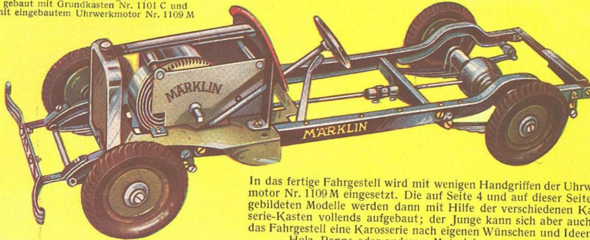
In das fertige Fahrgestell wird mit wenigen Handgriffen der Uhrwerkmotor Nr. 1109 M eingesetzt. Die auf Seite 4 und auf dieser Seite abgebildeten Modelle werden dann mit Hilfe der verschiedenen Karosserie-Kasten vollends aufgebaut; der Junge kann sich aber auch auf das Fahrgestell eine Karosserie nach eigenen Wünschen und Ideen aus Holz, Pappe oder anderem Material zusammenbasteln
