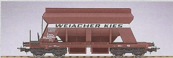
Vierachsiger Kieswagen eingestellt bei der Schweizerischen Bundesbahn, „Weiacher Kies“. Federpuffer, Kupplungsaufnahme und Kurzkupplungskinematik nach NEM. Epoche IV/V. LüP 162mm.
