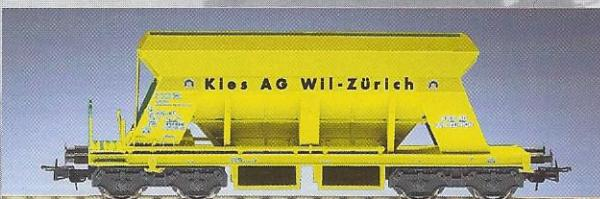
Vierachsiger Kieswagen eingestellt bei der Schweizerischen Bundesbahn, „Kies AG Wil“, gelb. Federpuffer, Kupplungsaufnahme und Kurzkupplungskinematik nach NEM. Epoche IV/V. LüP 162mm.
