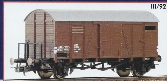
Gedeckter Güterwagen, Bauart Gms, der ÖBB, mit Bremserbühne, feinste Modellausführung, NEM-Schacht, Federpuffer, Epoche III. LüP 112 mm.
