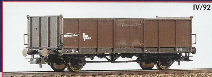
Zweiachsiger, offener Güterwagen der Graz-Köflacher-Bahn, technische Ausführung wie Modell 340106. LüP 116 mm.
