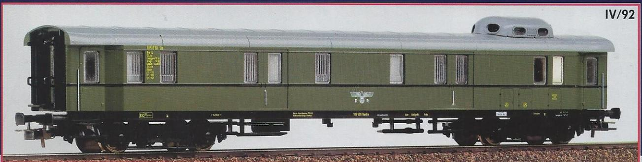
D-Zug-Gepäckwagen mit windschnittiger Zugführerkanzel der DRG, feinste Modellausführung und Beschriftung, Kurzkupplungskinematik mit NEM-Schacht, Epoche II. LüP 249 mm.
