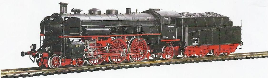
18 03 Schnellfahr-Dampflokomotive 2'C1' der Deutschen Bundesbahn mit 2 m Ø Räder, Windleitbleche, Nr. 18451. Zustand nach dem Zweiten Weltkrieg bis Ausmusterung. Farbe schwarz, rot. Tenderantrieb. Feinste Modellausführung. LüP 262 mm, Gewicht 540 g.
