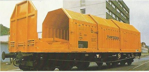
**222 00** Spezialwagen für den Transport nässeempfindlicher Güter der Firma Thyssen AG. aufgebaut auf Flachwagen Sa 705 LüP 152 mm
