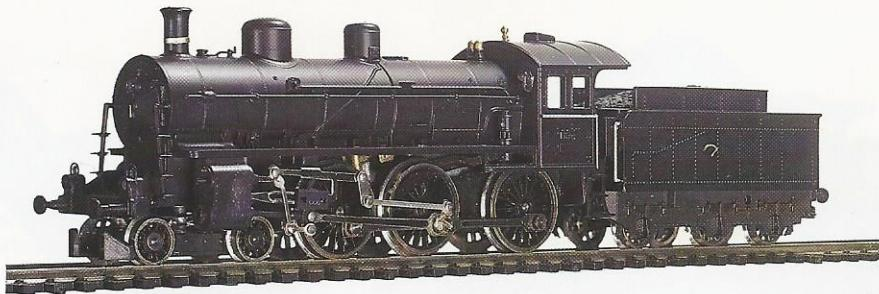
**107 50** Vierzylinder-Heißdampf-Schnellzug-Lokomotive der Serie A3/5-600 der SBB mit dreiachsigem Tender. Die schweizerische Lokomotivfabrik in Winterthur baute 1907 von dieser Lokomotive 49 Stück. LÜP 213 mm, Gewicht 390 g.
