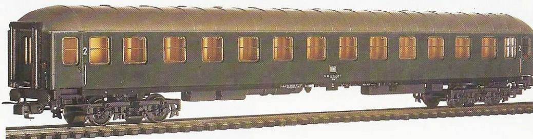
**896 00** Reisezugwagen 2. Klasse der DB, Bauart Büm (232), mit Inneneinrichtung. LÜP 304 mm.
