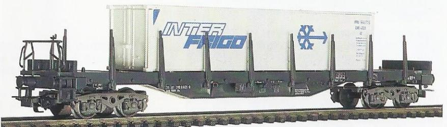
202 13 Vierachsiger Containerwagen der ÖBB, beladen mit einem abnehmbaren INTERFRIGO-40-ft-Container. LüP 227 mm.
