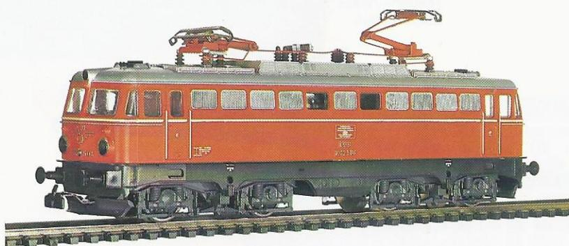
**114 11** Elektrische Lokomotive Reihe 1042.500, Achsfolge Bo'Bo' der ÖBB in neuer roter Farbgebung. Supermodell mit Einbein-Stromabnehmer, automatischem Lichtwechsel. Umschaltbar auf Oberleitung. LÜP 187 mm, Gewicht 410 g.
