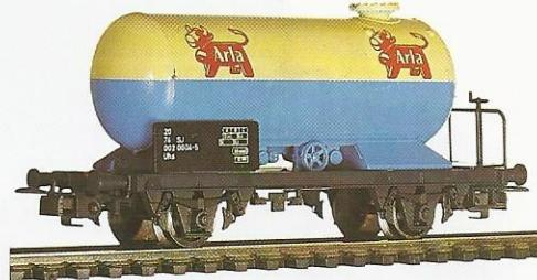
Schienenreinigungswagen mit Tank zum Einfüllen des Reinigungsöles.
