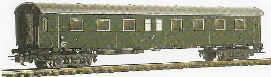
**280 10** Vierachsiger Schnellzugwagen 1./2. Klasse der ÖBB, Bauart N28, mit Inneneinrichtung. LüP 232 mm.
