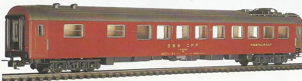
**880 50** Speisewagen der SBB, Serie WR 88-70. Dieser Wagen ist mit einem Stromabnehmer ausgerüstet, damit in der elektrischen Küche vorgekocht werden kann, noch ehe der Wagen in den Zugverband eingereiht wird. Vorbildliches Modell mit Inneneinrichtung. LÜP 304 mm.
