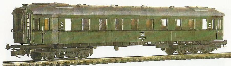
**286 00** Vierachsiger Schnellzugwagen 2. Klasse der DB. Umbau des Eilzugwagens E30, mit Faltenbälgen und Inneneinrichtung. LüP 240 mm.
