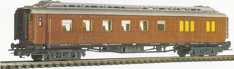
**260 00** Vierachsiger Speisewagen der CIWL mit Teak-Holzaufbau, Aufsatzdach und Inneneinrichtung. Nachbau des Wagens No. 2419 D. Waffenstillstandswagen 1919 und 1940, Versailles. LÜP 228 mm.
