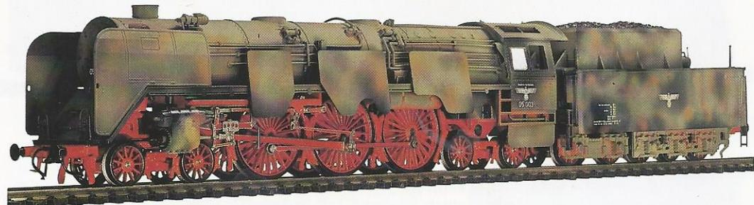
**105 22** Schnellfahr-Dampflokomotive 2'C2' der ehemaligen Deutschen Reichsbahn mit Splitterschutzplatten, Abblendlaternen und Sichtschutzbemalung. Das Gesicht der 05 als Reichsregierungslokomotive. Epoche II. **355**
