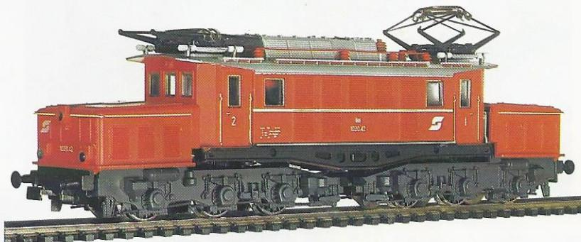
**119 11** Elektrolokomotive für Güterzüge. Baureihe 1020, Achsfolge Co'Co' der ÖBB in neuer roter Farbgebung. Mit Lichtwechsel und auf Oberleitung umschaltbar. LÜP 212 mm, Gewicht 485 g.
