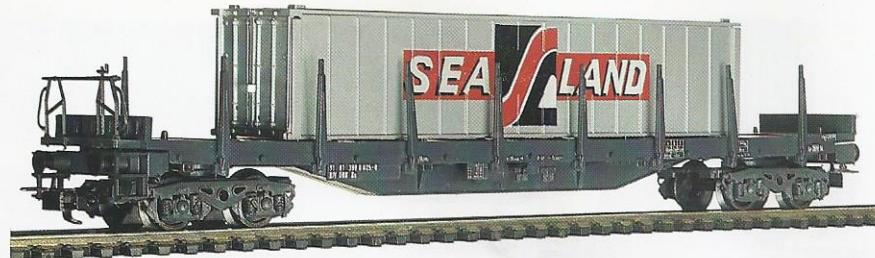
202 10 Vierachsiger Containerwagen der ÖBB, beladen mit einem abnehmbaren SEALAND-40-ft-Container. LüP 227 mm.
