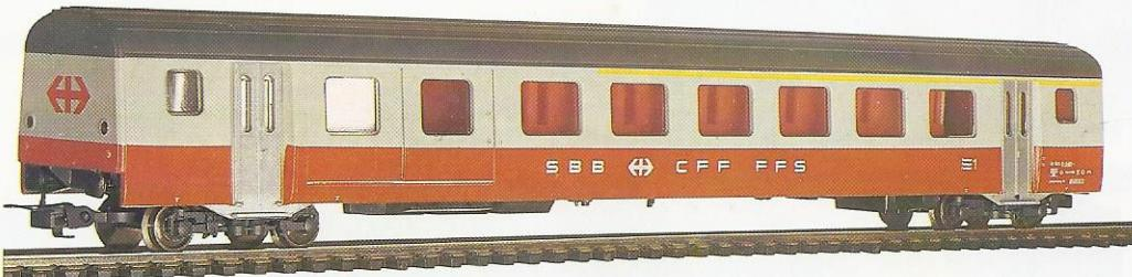
**887 50** Einheitswagen Type III mit Querneigungseinrichtung, 1. Klasse mit Gepäckabteil, Serie AD. LüP 280 mm.
