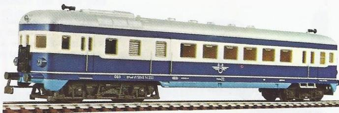
ÖBB Reihe VT 5046 Dieselhydraulischer Schnelltriebwagen
