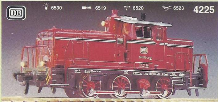
**4225 · Modell der C-dieselhydraulischen Lokomotive der DB. Baureihe 261. Mit Blindwelle. LÜP: 123 mm.**
