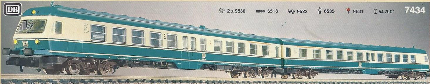
**7434 · Modell des 2-teiligen Dieseltriebzuges der DB. Baureihe 614. Moderne "ozeanblau/beige" DB-Lackierung. LÜP: 334 mm.** Alle technischen Einzelheiten sind wie bei 7430. Vorbild des Zuges sind die Wagen 614 083 sowie 614 084. Die Deutsche Bundesbahn verwendet diese Triebwagen-Züge schwerpunktmäßig in ihrem Netz. So sind im Süden die orange-perlweißen Garnituren – Vorbilder der 7430
