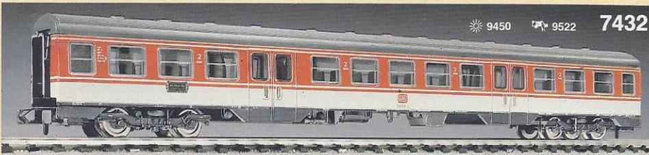
**7432 · Modell des Triebwagen-Mittelwagens der DB. Baureihe 914. Ohne Motor. Länge über Wagenkasten: 160 mm.** Modell in Super-Detaillierung, -Lackierung und -Beschriftung. Eingesetzte Fenster. 2 bewegliche Drehgestelle mit allen Einzelheiten. Dach abnehmbar zum Einbau der Innenbeleuchtungs-Garnitur 9450. Vorbild dieses Wagens ist der 914 019.
