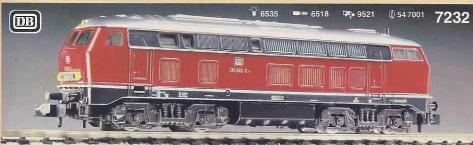
**7232** · Modell der B'B' dieselhydraulischen Mehrzweck-Schnellfahrlok der DB. Baureihe 210. LÜP: 102 mm.
