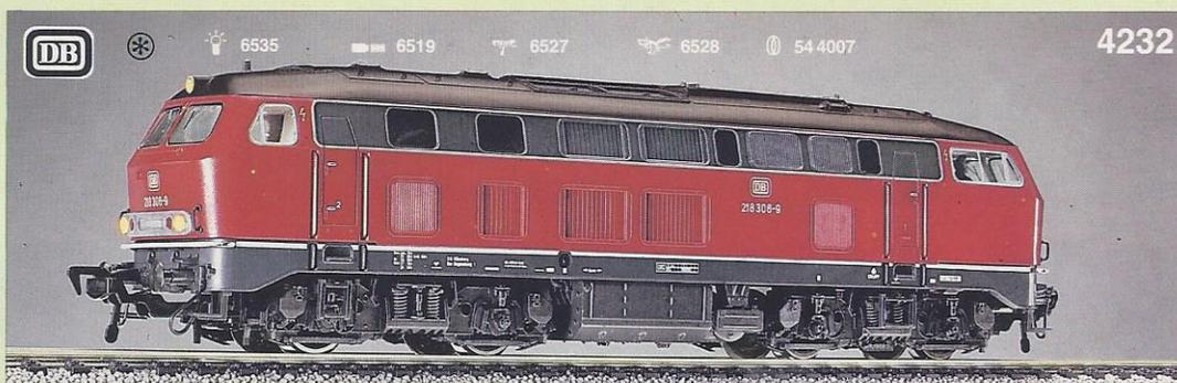
Die DB Original-Lok leisten 2059 kW (2800 PS), wiegt 79 Tonnen und erreicht 140 km/h Höchstgeschwindigkeit. Die Bundesbahn hat 410 Loks dieser Baureihe. Sie befördert damit schnelle Reise- und Güterzüge.
