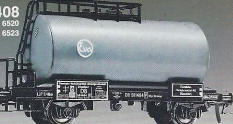
**5403 · Einheits-Leichtkesselwagen der DB, LüP: 116 mm.**
