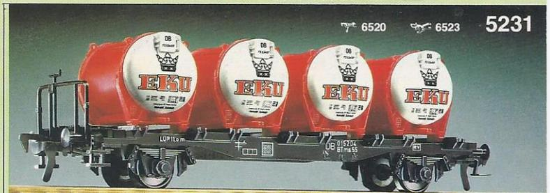
5231 · Behältertragwagen, Modell des BTms 55 der DB, LüP: 135 mm. Beladen mit 4 abnehmbaren Flüssigkeits-Behältern, Bauart Ddkr<sup>624</sup> der EKU- Brauerei Kulmbach.
