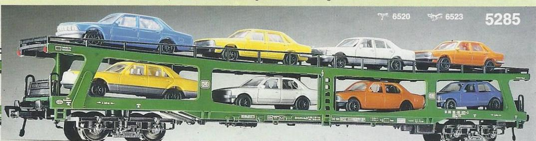
5285 · Doppelstockwagen für Autotransport (u. a. in D-Zügen "Auto im Reisezug"), 4-achsig, Modell des DDM<sup>915</sup>, LüP: 264 mm. Grüne DB-Lackierung mit vorbildentsprechender Beschriftung, Überfahrbleche an den Pufferbohlen vorbildentsprechend umklappbar, am Wagenboden und am Fahrgestell alle Einzelheiten nachgebildet, Original Minden-Deutz-Drehgestelle, mit **8 abnehmbaren** Modellen beladen.
