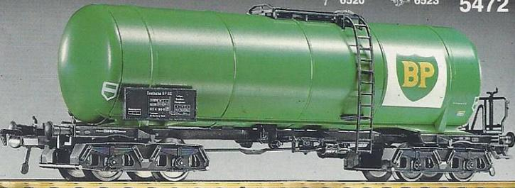
**5472 · Kesselwagen "BP", Modell eines 77 m<sup>3</sup> Flüssigkeits-Transport-Wagens, LüP: 165 mm.**
