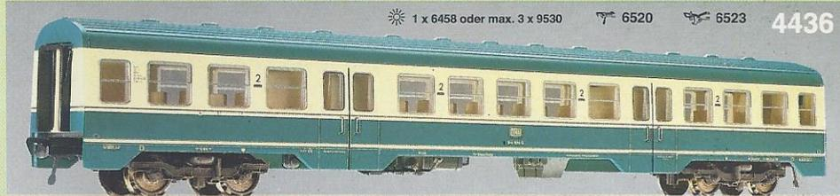
**4436 · Modell des Triebwagen-Mittelwagens der DB. Baureihe 914. Ohne Motor. Moderne "ozeanblau/beige" DB-Lackierung. Länge über Wagenkasten: 257 mm.**
