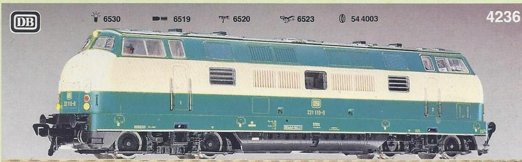
Das Original hat die Nummer 221110-0, leistet 2 x 994 kW (2 x 1350 PS), wiegt 81 t und erreicht 140 km/h Höchstgeschwindigkeit. Ihr Einsatz-Gebiet entspricht dem der Nummer 4235. Das Modell hat die moderne DB-Einheits-Lackierung erhalten.
