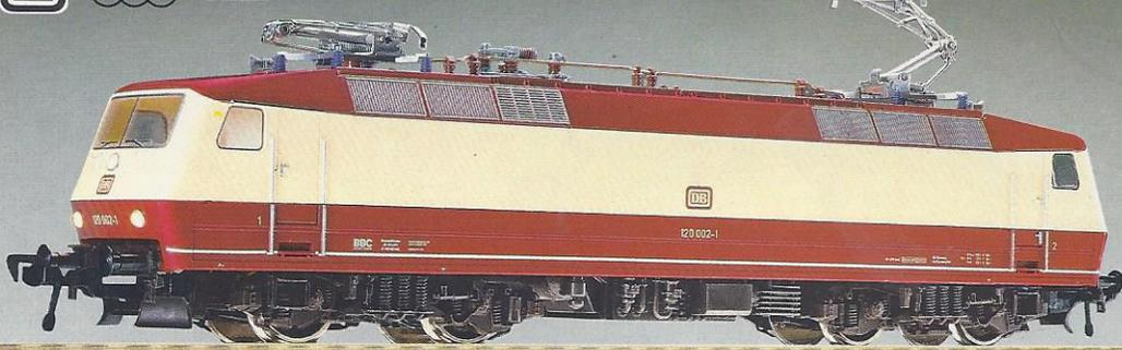
Die DB baut zunächst einmal 5 Prototypen einer ganz modernen, völlig neuen Traktions-Art. Es handelt sich um die Krauss-Maffei/Thyssen-Henschel/Rhein Stahl-Krupp Drehstrom-Elokok mit der Achsfolge Bo'Bo'. Mit ca. 4416 kW (6000 PS) und einem Gewicht von nur 84 Tonnen erreicht sie zunächst eine Höchstgeschwindigkeit von 160 km/h (später 200!). Aufgrund ihrer neuartigen Konstruktions-Prinzipien ist sie mühelos in der Lage, schwere Güterzüge wie auch TEE und IC zu ziehen!
