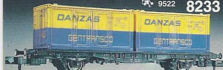
8233 · Container-Tragwagen der DB, Bauart Lbs 598, mit Containern der DANZAS-Speditionsges., LüP: 90 mm.
