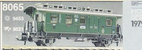
**8065** · Personenwagen 3. Klasse mit Gepäck-Abteil. Modell des CPwi Pr 05a der ehem. DR. LüP: 68 mm. Mit Inneneinrichtung, eingesetzte Fenster, teilweise mit Schutzgittern, am Wagenboden und Fahrgestell alle Einzelheiten nachgebildet, mit Innenbeleuchtungsgarnitur 9453 beleuchtbar.
