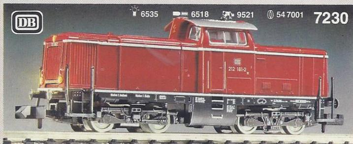
Mehr als 750 Loks dieser Baureihe werden vorwiegend vor Reise- und Güterzügen eingesetzt. Im Streckendienst fahren sie auch im Wendezugbetrieb. Das heißt, daß die Lok immer an einer Stelle am Zug verbleibt. In der einen Richtung zieht sie ihn, in der Gegenrichtung schiebt sie ihn.
