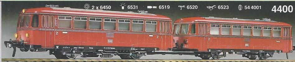
**4400 · Schienen-Omnibus-Garnitur. Modell des VT 998 der DB, mit Steuerwagen VS 998, Länge der Garnitur über Puffer: 305 mm.** Modell vorbildentsprechend detailliert, lackiert und beschriftet. Darstellung aller Details. Eingesetzte Cellonfenster in den Gehäusen. Scheibenwischer-Attrappen an den Führerstandseiten. Beidseitige
