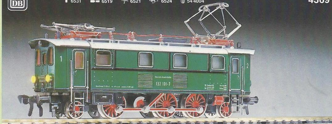
Das Original hatte die Nummer 132 101-7, leistete 1178 kW (1600 PS), wog 85 Tonnen und fuhr 90 km/h schnell. Es gab 24 Loks dieser Baureihe, die Güterzüge auf Haupt- und Nebenstrecken vorwiegend mittelschwere Reise- und beförderten.
