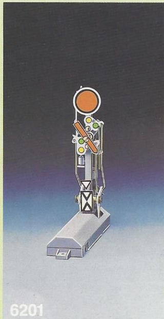
**6201 · Form-Vorsignal, ungekoppelt – für drei Begriffe.** Zwei elektromagnetische (getrennt schaltbare) Doppelspulenantriebe betätigen wahlweise die Signalscheibe oder den Zusatzflügel, davon abhängiger vorbildgetreuer Lichtwechsel, viele fein detaillierte Einzelheiten, Masthöhe 60 mm, mit 2 Anschraubfüßen.
