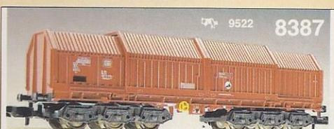
8387 · Teleskop-Haubenwagen der DB, Modell des Sahimms<sup>900</sup>, LüP: 94 mm. Mittlere Hauben verschiebbar. 2 Coils als herausnehmbares Ladegut, originalentsprechende DB-Lackierung und -Beschriftung mit 2 dreiaxigen Drehgestellen.
