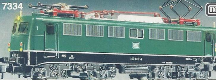
**7334 · Modell der Bo'Bo'-Mehrzweck-Elokom der DB, Baureihe 140<sup>8</sup>. LÜP: 106 mm.** Alle technischen Einzelheiten entsprechen denen der Lok 7333.
