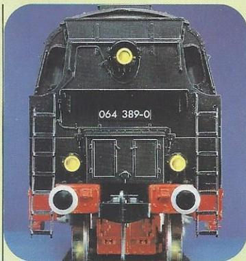
Das Original hatte die Nummer 064 389-0, leistete 699 kW (950 PS), wog 74,9 Tonnen, fuhr vorwärts und rückwärts 90 km/h und wird von Kennern "SCHWARZER BUBIKOPF" genannt. 520 Lokomotiven dieser Baureihe beförderten leichte Güter- und Reisezüge auf Haupt- und Nebenbahnen. Die Eisenbahn-Freunde "Zollernbahn" besitzen auch heute noch einen "Bubikopf" für Dampflok-Sonderfahrten.
