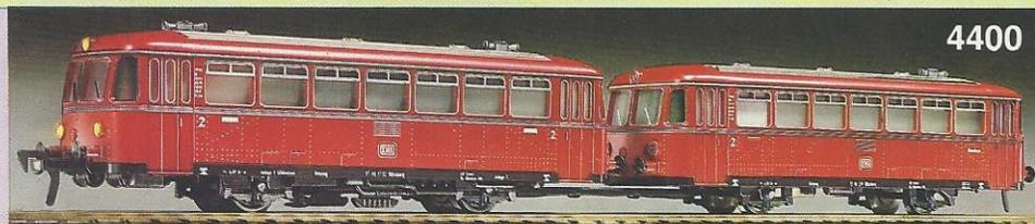
4400 · Schienen-Omnibus-Garnitur. Modell des VT 798 der DB, mit Steuerwagen VS 998, Länge der Garnitur über Puffer: 305 mm. Modell vorbildentsprechend detailliert, lackiert und beschriftet. Darstellung aller Details. Eingesetzte Cellonfenster in den Gehäusen. Scheibenwischer-Attrappen an den Führerstandseiten. Beidseitige
