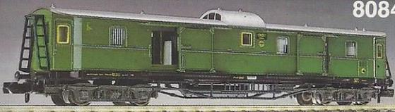
8084 · Gepäckwagen, Modell des Pw 4 Pr 04 der ehem. DR, LüP: 116 mm, mit 2 Drehgestellen der preußischen Regel-Bauart. Mit Inneneinrichtung, 4 bewegliche Schiebetüren am Gepäckabteil. Einbau der Innenbeleuchtungsgarnitur 9459 möglich.
