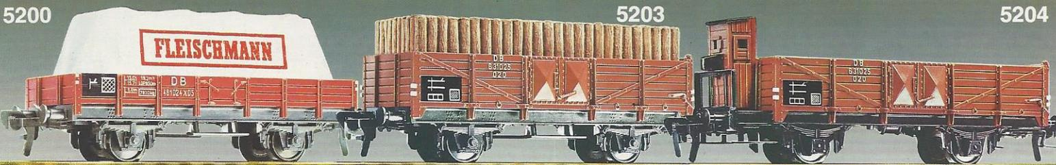
5200 · Niederbordwagen mit Planentuch, Modell des X 05 der DB, LüP: 99 mm. Rotbraune DB-Lackierung mit vorbildentsprechender Beschriftung, Ladegut abnehmbar.
