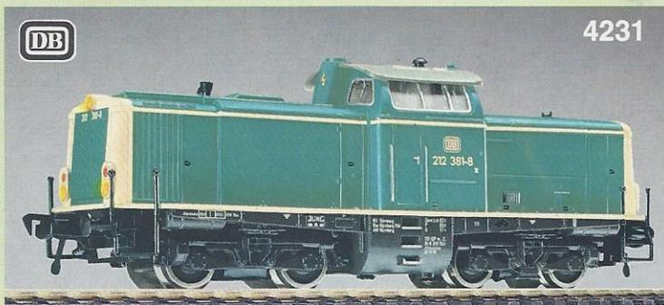
Das Original hat die Nummer 212 381-8, leistet 994 kW (1350 PS), wiegt 63,5–65,5 Tonnen und fährt im Streckengang 100 km/h und im Rangiergang 65 km/h. Ihr Einsatz-Gebiet entspricht jenem der Nummer 4230. Dieses Modell hat lediglich die modernen Einheitslackierungen der DB erhalten.
