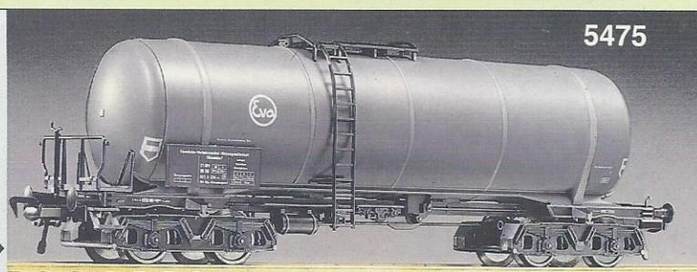
**5475** Kesselwagen "EVA", Modell eines 77 m<sup>3</sup> Flüssigkeits-Transport-Wagens, Lüp: 165 mm. Vorbildentsprechende Lackierung und Beschriftung.
