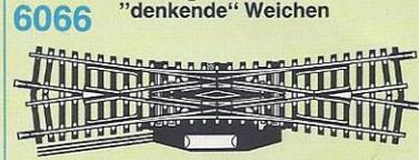
**6066** · Doppelte Kreuzungsweiche 15° mit el.-magn. Doppelspulen-Antrieb (Endabschaltung), "elektrisch durchgeschaltet". Bei Entfernung der Drahtbrücken sind die sich kreuzenden Gleise voneinander elektrisch getrennt, bei Bogenfahrt bleiben sie miteinander verbunden, Vorteil beim Überfahren anderer Stromkreise. Die Länge der sich kreuzenden Geraden ist 219,5 mm.
