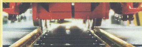
Messing-Vollprofil-Gleise für 2-Leiter-Fahrbetrieb
