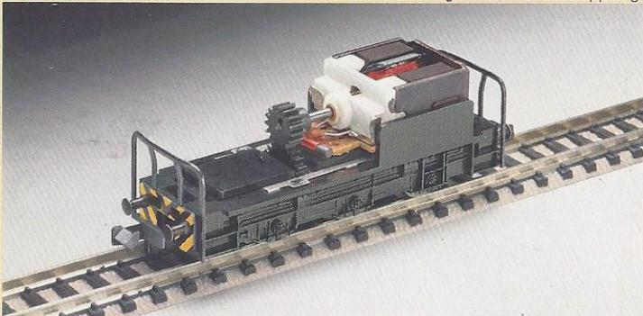
**7230 · Modell der B'B' dieselhydraulischen Mehrzwecklok der DB. Baureihe 212. LüP: 78 mm.**
