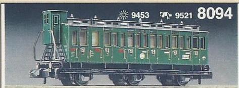
**8094** · Abteilwagen 3. Klasse mit Bremserhaus, Modell des C3 der ehem. DR, LÜP: 69 mm. Mit Inneneinrichtung, 3-achsig, mittlere Achse seitenverschiebbar, eingesetzte Fenster, alle Einzelheiten nachgebildet, mit Innenbeleuchtungsgarnitur 9453 beleuchtbar.
