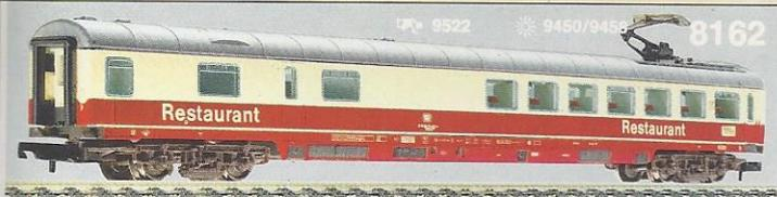
8162 · TEE-, IC-Fernschnellzug-Speisewagen, Modell des WRmz<sup>135</sup> der DB, LüP: 170 mm. Mit Inneneinrichtung, eingesetzte Fenster, beweglicher Einholmstromabnehmer (ohne elektr. Funktion, beim Vorbild zur Abnahme von Betriebsstrom aus der Oberleitung, wenn der Wagen nicht von einem Triebfahrzeug versorgt wird). Weitere vorbildentsprechende Details auf dem Dach, alle Einzelheiten nachgebildet. Dach abnehmbar zum Einbau der Innenbeleuchtungsgarnitur 9458 oder 9450.
