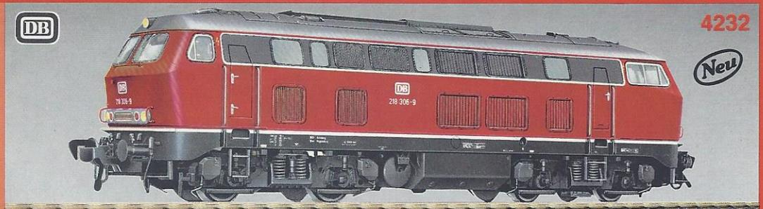
Das Original hat die Nummer 218 306-9, leistet 2059 kW (2800 PS), wiegt 79 Tonnen und erreicht 140 km/h Höchstgeschwindigkeit. Die Bundesbahn hat 410 Loks dieser Baureihe. Sie befördert damit schnelle Reise- und Güterzüge.
