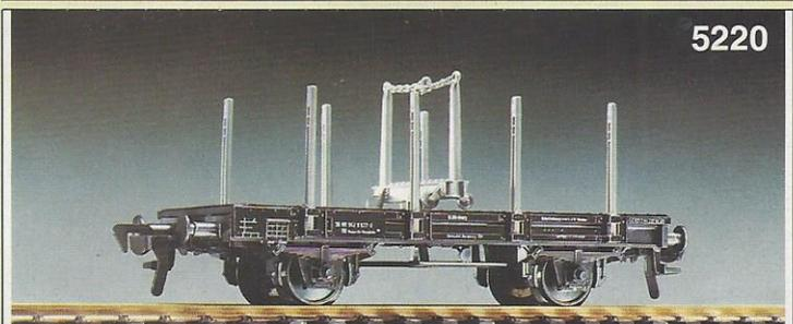
5220 · Drehschemelwagen der DB, Bauart H 10, LüP: 99 mm. Vorbildentsprechende Lackierung und Beschriftung, Drehschemel in Wagenmitte drehbar montiert.
