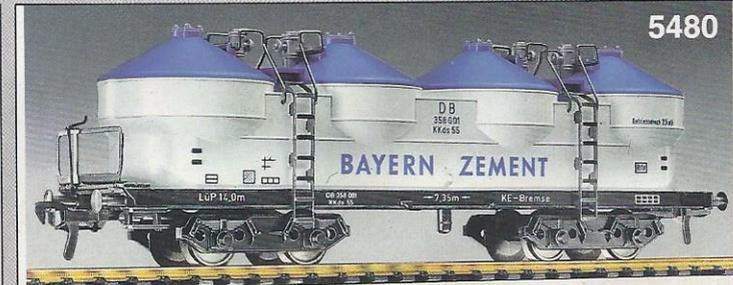
5480 · Zementtransportwagen "BAYERN ZEMENT", 4-achsig, Modell des Feinschüttgut-Transportwagens KKds 55 der DB für Druckluftentleerung, LüP: 170 mm.
