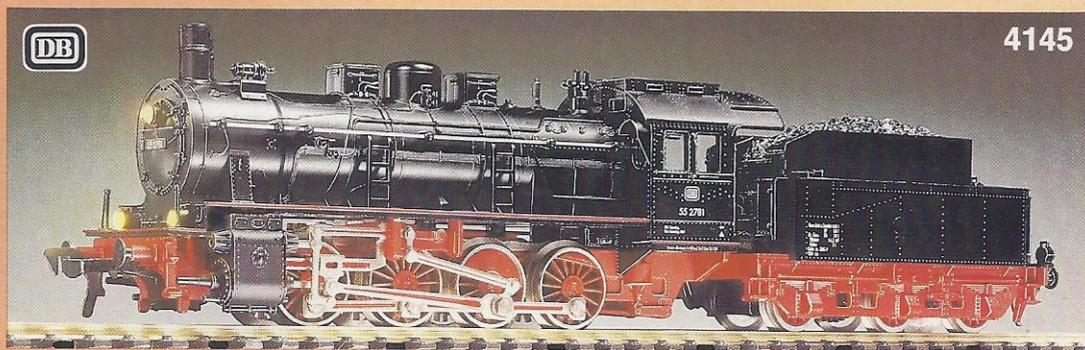
**4145 - Modell der D h2-Mehrwecklokomotive der DB. Baureihe 5525 (ehem. G 8' der Preussischen Staatsbahn). LüP: 223 mm.**
