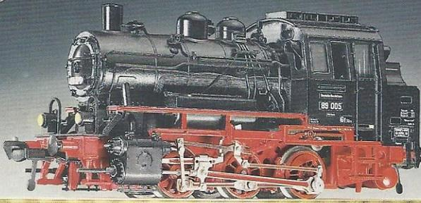
**4020 · Modell der C h2 Tenderlokomotive der DRG, Baureihe 89° (Einheits-Lokomotive), Lüp: 111 mm.**
