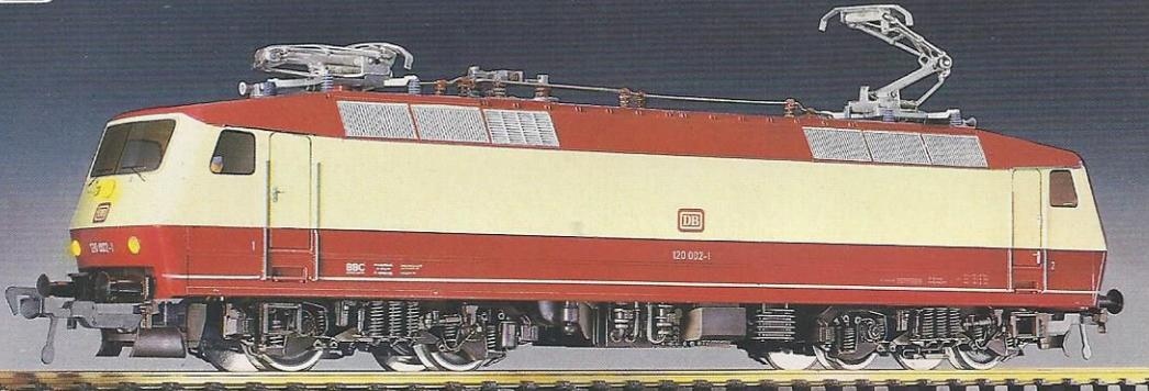
Die DB baut zunächst einmal 5 Prototypen einer ganz modernen, völlig neuen Traktions-Art. Es handelt sich um die Krauss-Maffei/Thyssen-Henschel/Rhein Stahl-Krupp Drehstrom-Elokok mit der Achsfolge Bo'Bo' und der Baureihe 120. Mit ca. 6000 PS und einem Gewicht von nur 84 Tonnen erreicht sie zunächst eine Höchstgeschwindigkeit von 160 km/h (später 200!). Aufgrund ihrer neuartigen Konstruktions-Prinzipien ist sie mühelos in der Lage, schwere Güterzüge wie auch TEE und IC zu ziehen.
