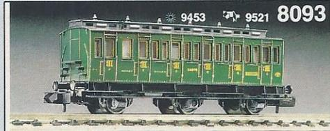
8093 · Abteilwagen 3. Klasse, Modell vieler europ. Bahnverwaltungen, LüP: 69 mm. **Mit Inneneinrichtung**, 3-achsig, mittlere Achse seitenschiebbar, eingesetzte Fenster, alle Einzelheiten nachgebildet, mit Innenbeleuchtungsgarnitur 9453 beleuchtbar.
