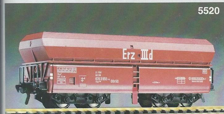
**5520** · Großraum-Selbstentladewagen, Modell des "Fad167" der DB, LÜP: 138 mm. Mit beweglichen Seitenklappen zur automatischen Entladung des Schüttgutes, rot-braune DB-Lackierung mit vor-
