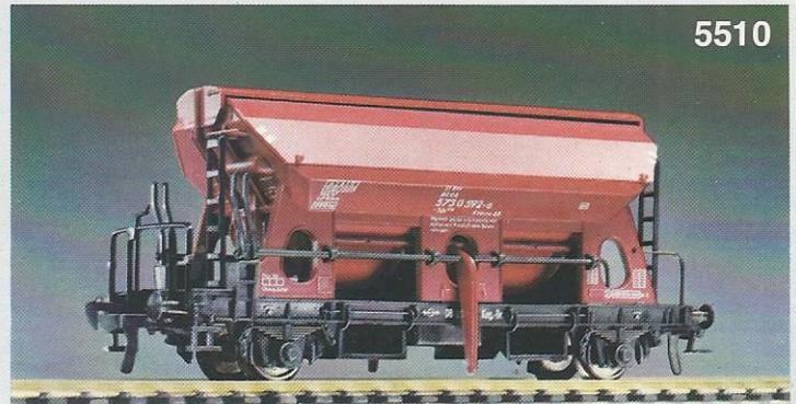
**5510** · Selbstentladewagen "Tds<sup>928</sup>" der DB, LüP: 122 mm. Mit beweglichem Schwenkdach und 4 beweglichen Schieberverschlüssen am Wagenboden zur automatischen Entladung des Schüttgutes
