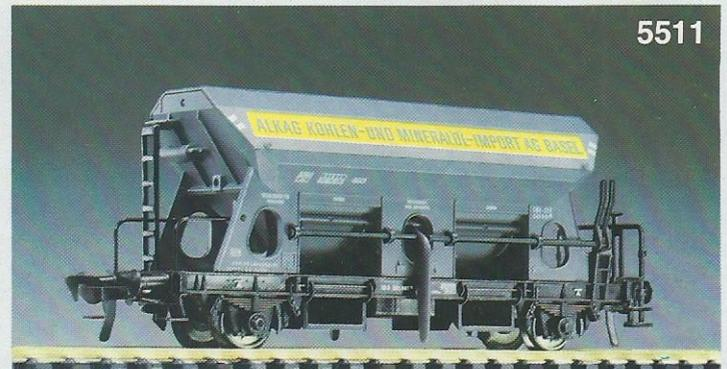
**5511** · Selbstentladewagen eines Schweizer Unternehmens, LüP: 122 mm. Mit 4 beweglichen Schieberverschlüssen am Wagenboden zur automatischen Entladung des Schüttgutes 6484,
