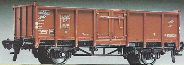
5205 · EUROP-O-Wagen der DB, Bauart "Omm 55", Lüp: 112 mm. Rotbraune DB-Lackierung mit vorbildentsprechender Beschriftung.
