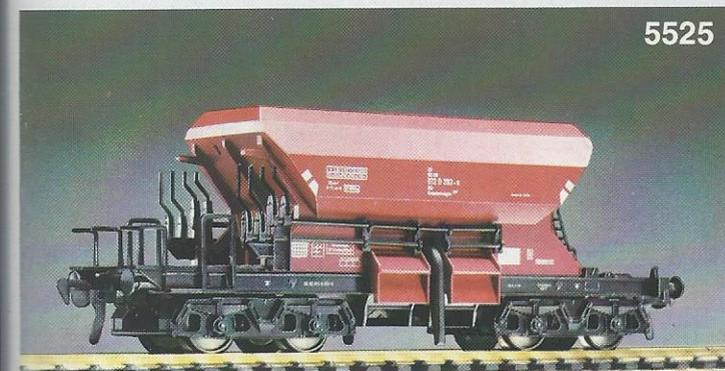
**5525** · Selbstentladewagen der DB, Modell der Gattung 626, LÜP: 133 mm, mit 4 beweglichen Schiebeverschlüssen am Wagenboden zur automatischen Entladung des Schüttgutes 6484, rotbraune
