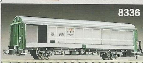
**8336** · Gedeckter Schiebewandwagen, Modell eines schweizerischen P.T.T.-Postgüterwagens, LüP: 88 mm, Vorbildentsprechend lackiert und beschriftet, mit 4 Seitenwänden zum Öffnen und Schließen.
