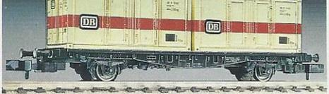
8234 · Container-Tragwagen der DB, Bauart "LBS 598", mit Containern der DB, LüP: 90 mm.
