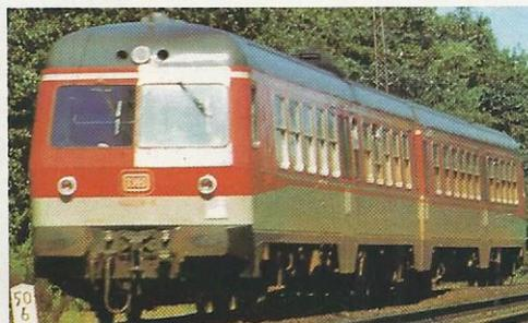
Die Triebwagen-Einheit 614 ist in ihrer Grund-Konzeption 2teilig + 1 Einheit Mittelwagen von der DB konzipiert und von der MAN, Werk Nürnberg, gebaut worden. Da das Sitzplatz-Angebot jedoch schwankend (mal mehr, mal weniger) ist, kann eine Einheit bis zu 2 Mittelwagen bekommen.
