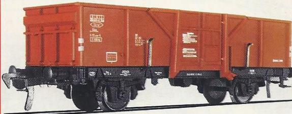
5502 · Mitten-Selbstentladewagen, Modell des EL-u<sup>000</sup> der DB, LÜP: 115 mm.
