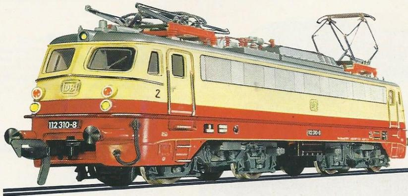
**4337 · Modell der Bo'Bo' TEE-Schnellfahrlokomotive der DB – BR E 10<sup>12</sup> – 4-achsig – LüP: 195 mm.**
