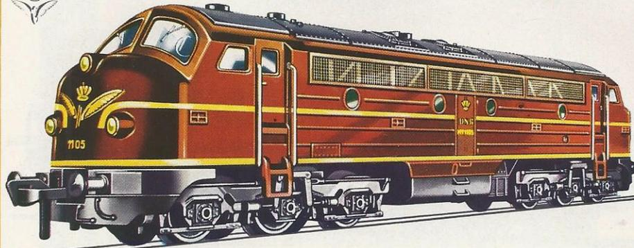
4271 - Modell der (A1A) (A1A) dieselelektrischen Mehrzweck-Lok der DSB – BR My 11 – 6-achsig – LüP: 223 mm.
