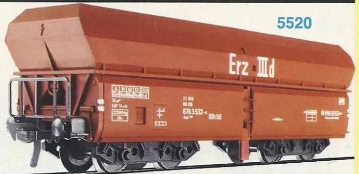
5520 · Großraum-Selbstentladewagen, Modell des "Fad<sup>167</sup>" der DB, LÜP: 138 mm. Mit beweglichen Seitenklappen zur automatischen Entladung des Schüttgutes, rotbraune DB-Lackierung mit vorbildentsprechender Beschriftung, Original DB-Einheitsgüterwagen-Drehgestelle. Diese Wagen dienen der DB zum Transport von Schwerlastgütern, z. B. Erz, Kalkstein, Kohle, Koks, Kies usw.
