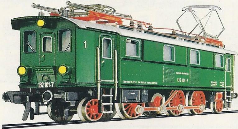
4369 - Modell der 1'C1'-Mehrzweck-Elokok der DB - BR E 32' (neue Bezeichnung 132) - 5-achsrig, mit Blindwelle - LÜP: 160 mm.
