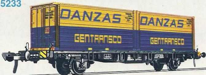
5233 · Container-Tragwagen der DB, Bauart „Lbs 598“, beladen mit 2 Stück 20'-Containern Htt 6<sup>252</sup> der DANZAS-Speditionses., LÜP: 170 mm.
