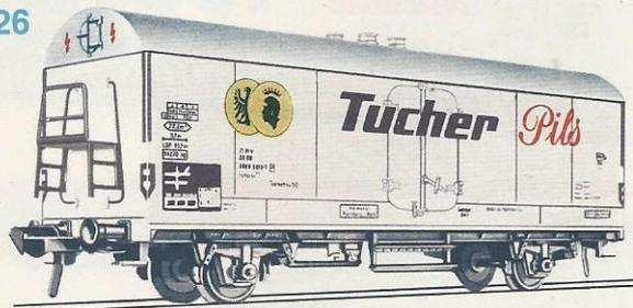
5326 - Kühlwagen der DB, Bauart „Tmmhss 50“, LüP: 137 mm, der TUCHER-BRAUEREI Nürnberg, vorbildentsprechende Lackierung und Beschriftung.
