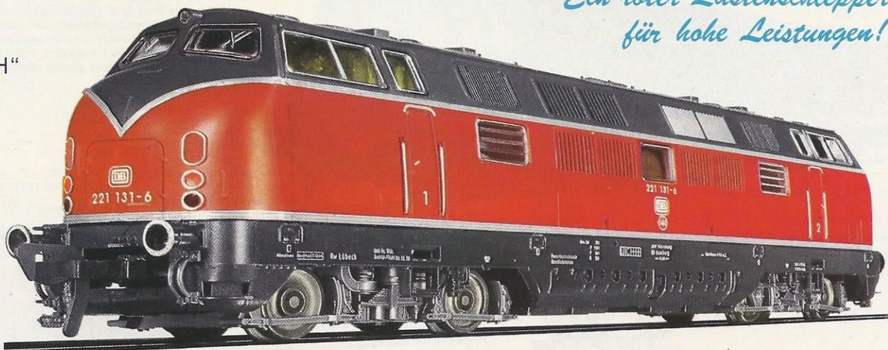
4235 - Modell der B'B' dieselhydraulischen Mehrzweck-Lok der DB - BR 221 - 4-achsige - LÜP: 213 mm.
