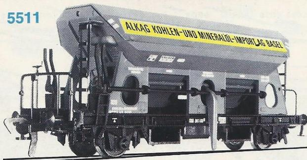
5511 · Selbstentladewagen eines Schweizer Unternehmens, LÜP: 122 mm. Mit 4 beweglichen Schieberschlüssen am Wagenboden zur automatischen Entladung des Schüttgutes 6484, graue SBB-Lackierung mit vorbildentsprechender Beschriftung. Die Eisenbahn befördert in diesem TEEM-fähigen Wagen Schüttgüter, zulässige Höchstgeschwindigkeit 100 km/h.
