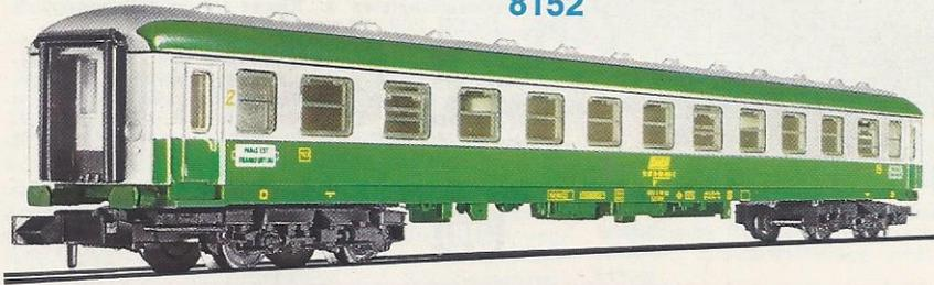
8152 · Schnellzugwagen 2. Klasse, Modell eines B<sup>11</sup> der SNCF, LüP: 165 mm.
