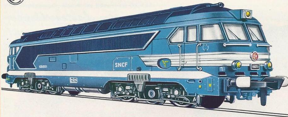
4280 - Modell der (A1A) (A1A) dieselelektrischen Mehrzweck-Lok der SNCF – BR 68 – 6-achsig – LüP: 208 mm.
