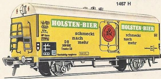
5322 · Kühlwagen der DB, Bauart „Tmehs 50“, LüP: 137 mm, der HOLSTEN-BRAUEREI Hamburg, vorbildentsprechende Lackierung und Beschriftung.
