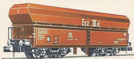
8520 - Großraum-Selbstentladewagen, Modell des Fad<sup>167</sup>, LüP: 72 mm. Mit beweglichen Seitenklappen zur automatischen Entladung des Schüttgutes 9484, rotbraune DB-Lackierung mit vorbildentsprechender Beschriftung, Original DB-Einheitsgüterwagen-Drehgestelle.
