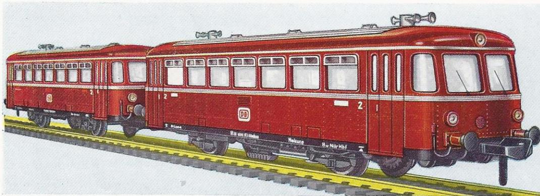
Schienen-Omnibus-Garnituren der Baureihe VT 98<sup>o</sup> erfreuen sich großer Beliebtheit. Zwei 150 PS-Unterflurmotoren ermöglichen eine Spitzengeschwindigkeit von 90 km/h. An den Stirnseiten normale Zug- und Stoßvorrichtungen zur Beförderung von Reisezug- und Güterzugwagen. Sie fahren oft auch in Mehrfach-Kompositionen als Personen- und Eilzüge.
