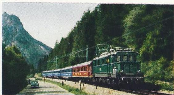
Die DB verwendet die Lokomotiv-Reihe E44 vorwiegend im süd-deutschen Raum zur Beförderung von mittelschweren Güter- und Reisezügen bis zu 90 km/h. – Die Entwicklung der E44 war die Geburtsstunde der modernen elektrischen Lokomotiven.
