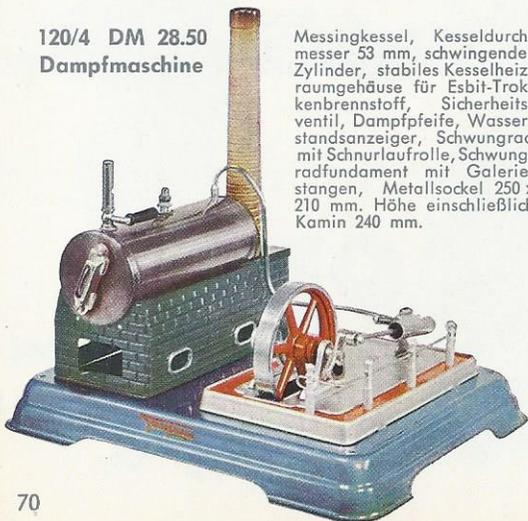
Messingkessel, Kesseldurchmesser 53 mm, schwingender Zylinder, stabiles Kesselheizraumgehäuse für Esbit-Trockenbrennstoff, Sicherheitsventil, Dampfpfeife, Wasserstandsanzeiger, Schwungrad mit Schnurlaufrolle, Schwungradfundament mit Galeriestangen, Metallsockel 250 x 210 mm. Höhe einschließlich Kamin 240 mm.
