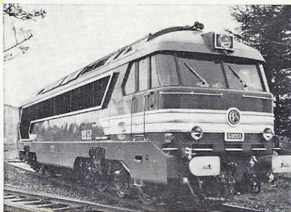
Das Vorbild dieser attraktiven Lokomotive ist A1A A1A diesel-elektrisch angetrieben, Höchstgeschwindigkeit 130 km/h, Motorleistung ca. 3000 PS, Gesamtgewicht 106 t.
