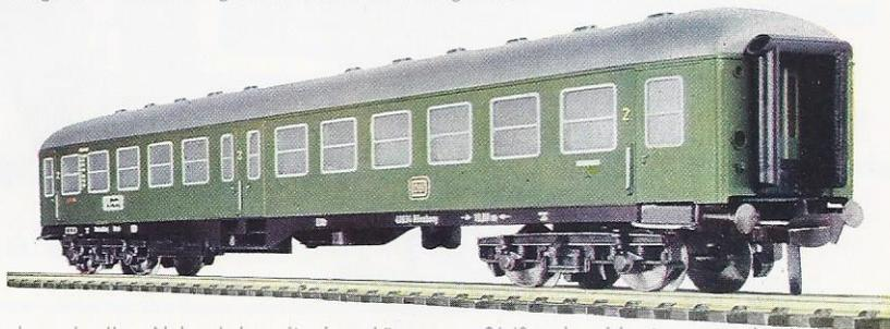
Diesen Eilzugwagen für den schnellen Nahverkehr mit einer Länge von 26,40 m bezeichnet man auch als „Städte-Schnellverkehrs-Wagen“.
