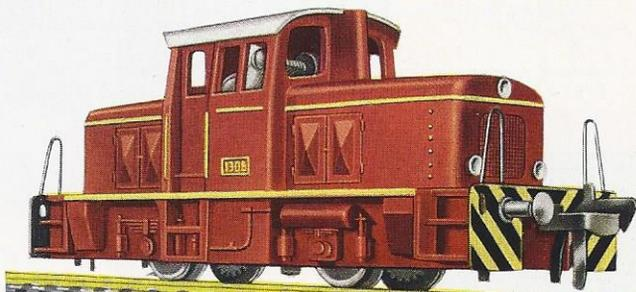
Das Vorbild unserer Lokomotive ist die Bauart-Reihe MV 9 einer namhaften Lokomotiv-Bauanstalt, die diese Lok in großen Stückzahlen für den Industrie-Bahnbetrieb baut.
